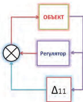
Рис. 2. Схема системы управления с аддитивной неопределенностью регулятора
