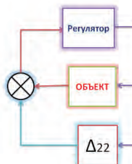
Рис. 5. Схема системы управления с аддитивной неопределенностью объекта
