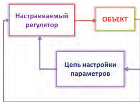
Рис. 7. Схема идентификационной адаптивной системы управления
