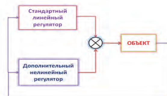
Рис. 6. Схема системы нелинейного робастного управления
