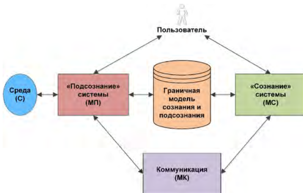
Рис. 1. Обобщенная архитектура ГИИС
