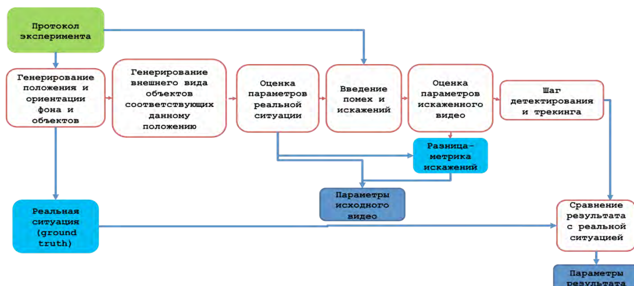
Рис. 7. Принцип работы системы оценки качества АОЭС НКМ
