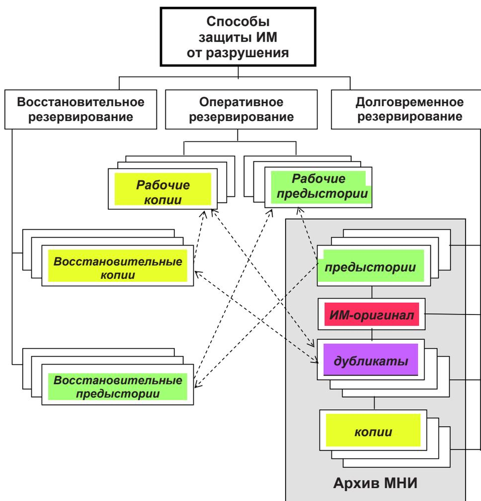
Рис. 8. Классификация способов и средств резервирования информационных массивов
