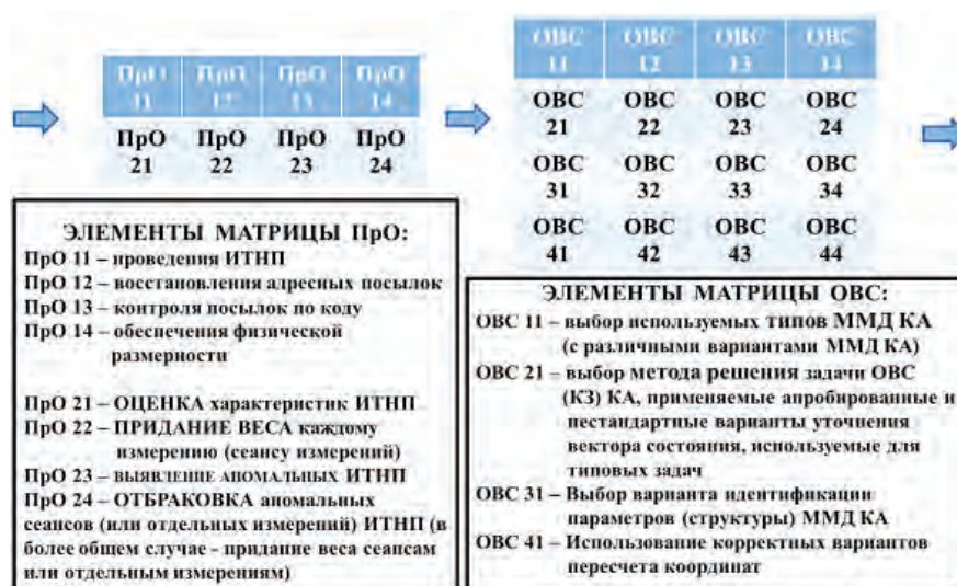
Рис. 3. Условное описание связи между отдельными матрицами проблем решения задач НБО управления КА
