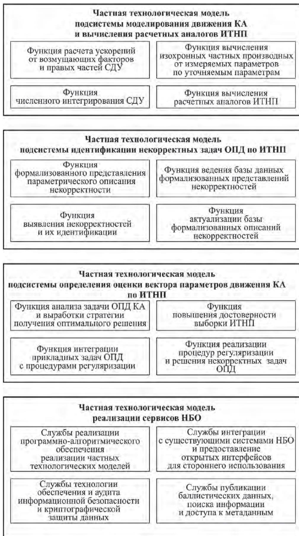
Рис. 11. Обобщенная технологическая модель оперативного определения параметров движения КА
