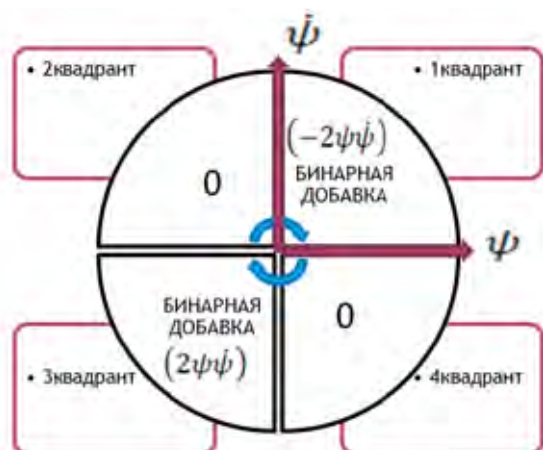
Рис. 2. Схема бинарного управления системы переменной структуры с адаптацией в особых состояниях на фазовой плоскости
