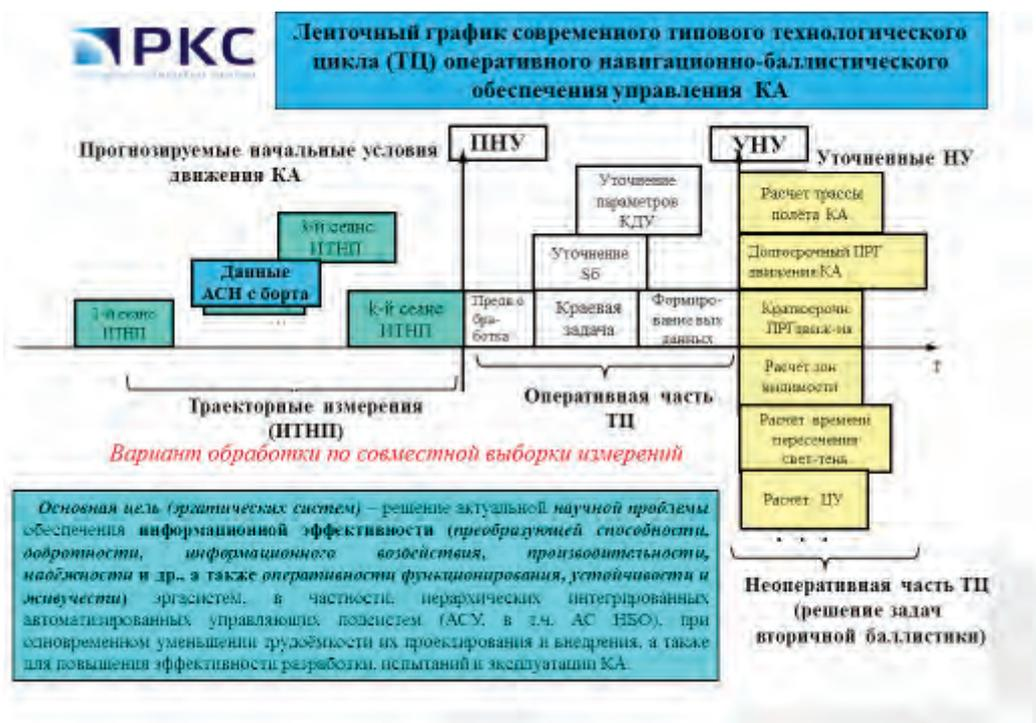
Экспликация (здесь и на рис. 2): ПНУ — прогнозируемые начальные условия движения; УНУ — уточненные начальные условия движения; ПрО — предварительная обработка; КДУ — корректирующая двигательная установка; ОВС — определение вектора состояний (краевая задача); СБ — баллистический коэффициент; NB — номер витка; НБИ — навигационно-баллистическая информация (t, R, H, B, L — момент времени, модуль радиус-вектора, высота, широта, долгота нахождения КА).
