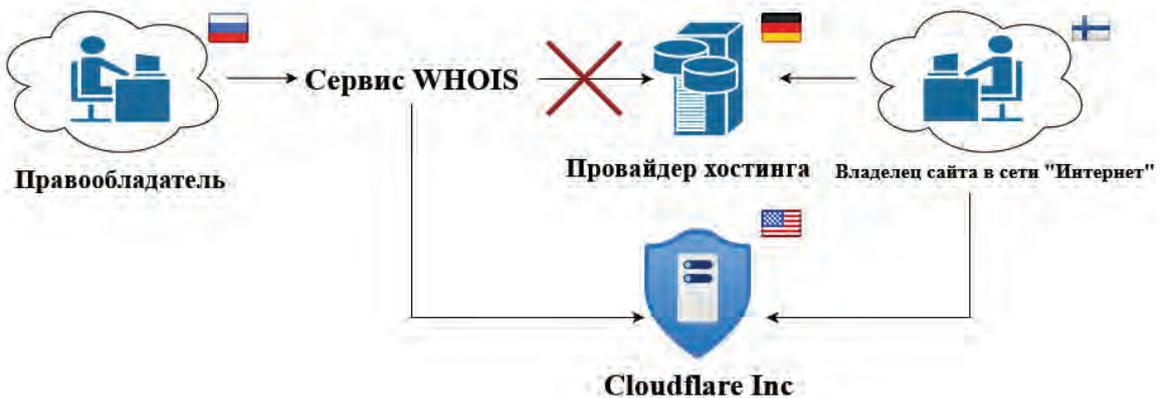
Рис. 6. Схема установления провайдера хостинга, если владелец сайта в сети Интернет использует сервис по защите от DDOS-атак
