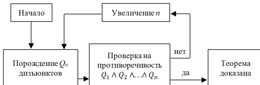
Рис. 3. Схема доказательства отсутствия опасных состояний архитектуры
