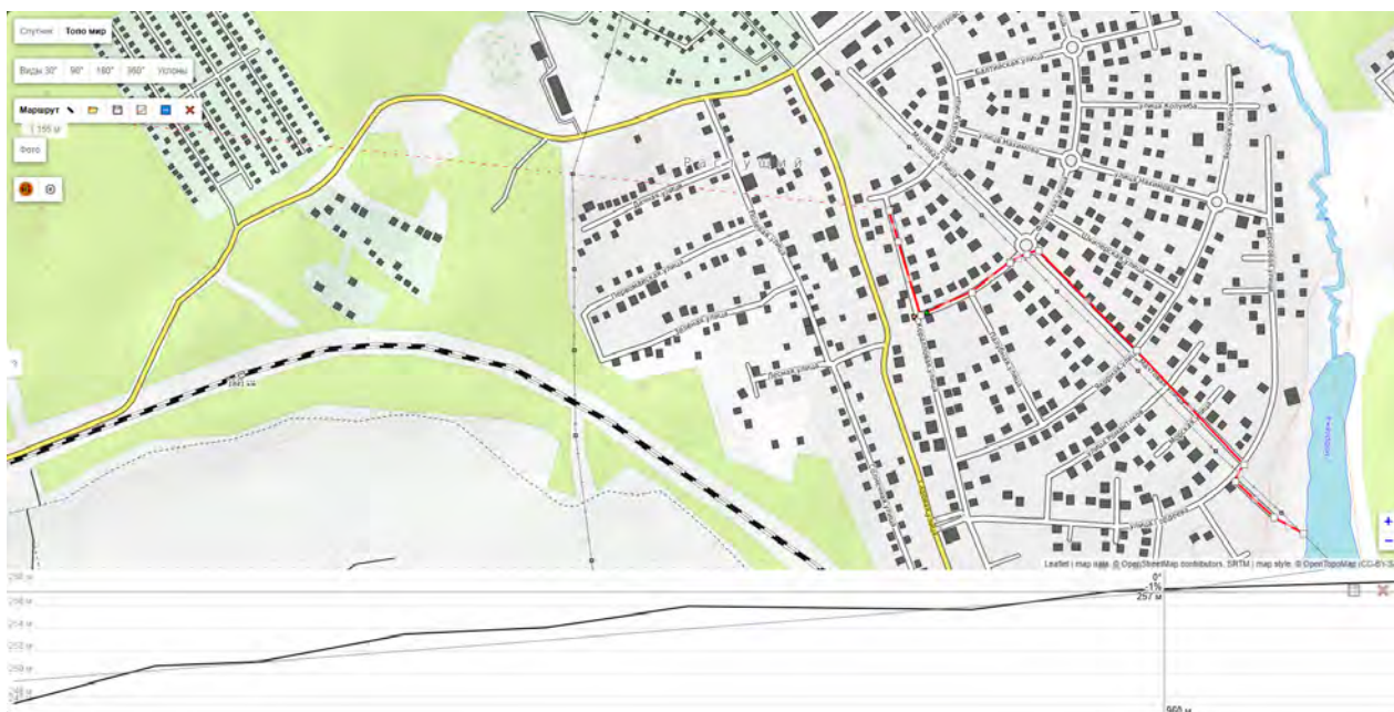
Рис. 1. Схема расположения водоисточника и маршрут до места пожара с указанием перепада высот и рельефа местности
