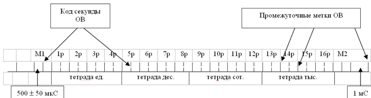
Рис. 9. Структура исходных сигналов двоично-десятичного кода секунд и промежуточных меток
