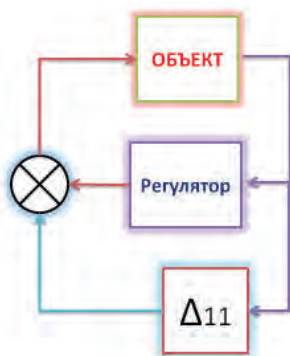
Рис. 2. Схема системы управления с аддитивной неопределенностью регулятора
