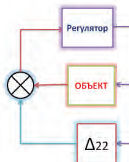
Рис. 5. Схема системы управления с аддитивной неопределенностью объекта
