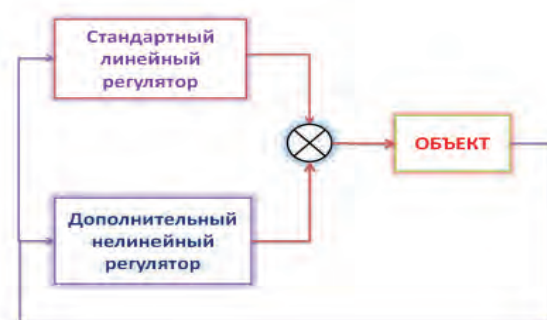
Рис. 6. Схема системы нелинейного робастного управления
