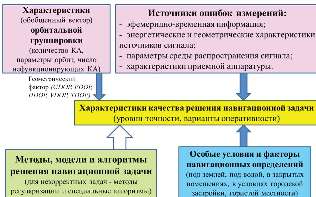
Рис. 3. Факторы, определяющие характеристики глобальных навигационных спутниковых систем
