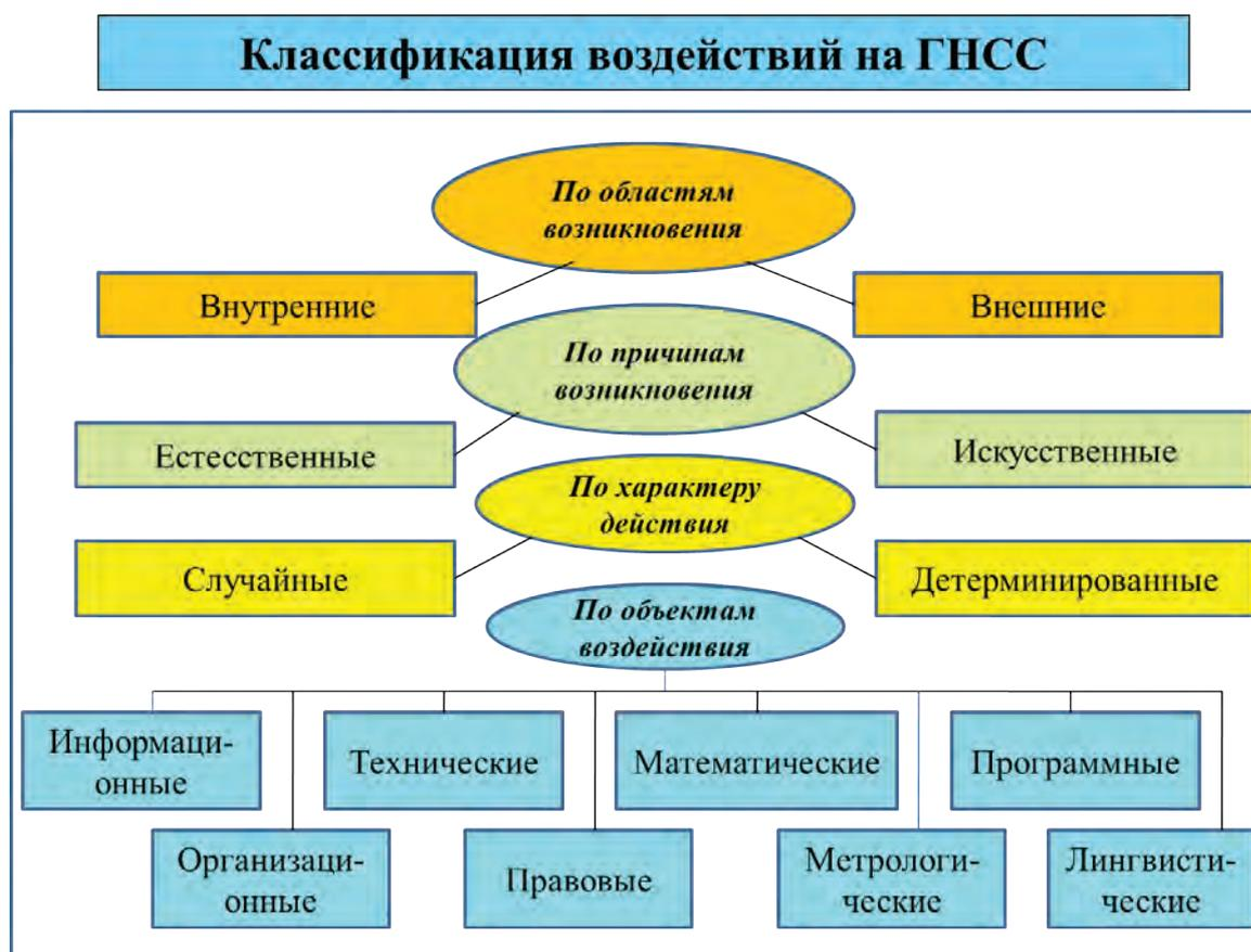
Рис. 11. Общая классификация деструктивных воздействий различного рода на глобальные навигационные спутниковые системы
