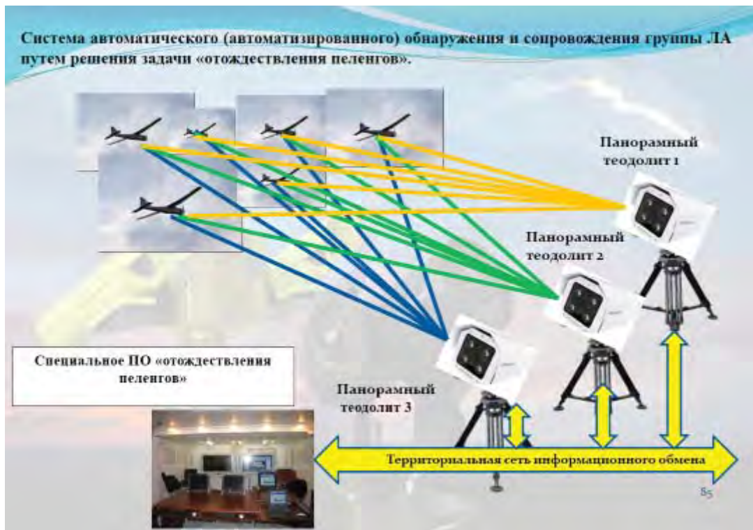
Рис. 3. Автоматическое обнаружение, слежение и оценка координат группового полёта дронов на основе отождествления пеленгов
